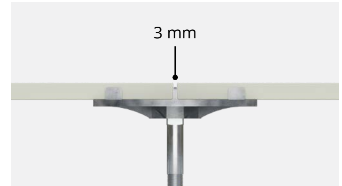
Pièces d'écartement intégrées largeur d'un joint 3 mm
