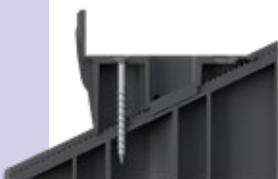
Einfache Fixierung der Keile mit Schrauben in den vorbereiteten Befestigungslöchern.
