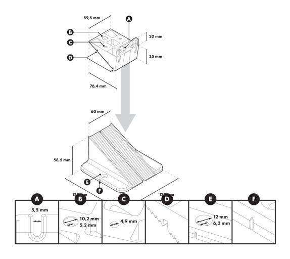
A) - orifice pour le montage de la solive pour la cale, B) - orifice pour le vissage de la cale à la base, C) - orifice pour le montage de la cale à la solive par le bas, D) - trous pour l'évacuation de l'eau, E) - orifice pour le montage optionnel à la base, F) - rainure marquant la direction correcte de la base L par rapport à la base 30 mm
