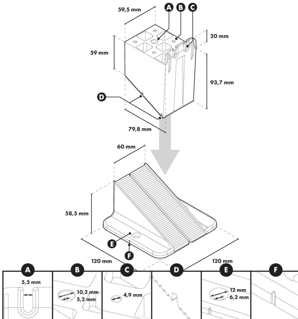
A) - orifice pour le montage de la solive pour la cale, B) - orifice pour le vissage de la cale à la base, C) - orifice pour le montage de la cale à la solive par le bas, D) - trous pour l'évacuation de l'eau, E) - orifice pour le montage optionnel à la base, F) - rainure marquant la direction correcte de la base L par rapport à la base 30 mm
