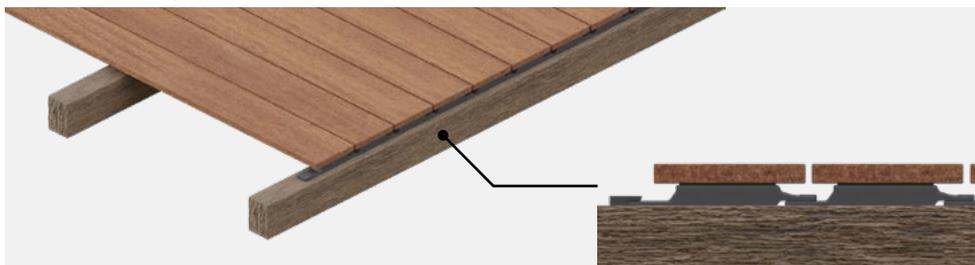
**Assemblage invisible** pour lames de terrasse DECK-DRY - clip avec kit de vis LARGEUR DE LA LAME 138 - 145 mm (~20 pcs/m<sup>2</sup>)
