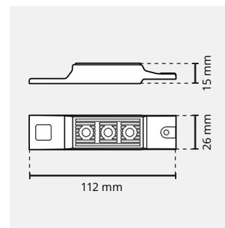
**Assemblage invisible** pour lames de terrasse DECK-DRY - clip avec kit de vis LARGEUR DE LA LAME 112 - 121 mm (~24 pcs/m<sup>2</sup>)
